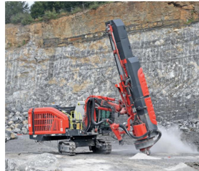
Aktiviert ist im DX800i Silencer der Firma Keckeis auch das Sandvik TIM3D Navigationssystem für Übertage-Bohrgeräte. Es ermöglicht durch Nutzung der GPS-Technik die schnellere und präzisere Positionierung der Bohrlöcher für ein verbessertes Bohrergebnis mit einer Genauigkeit von +/- 10 cm. Die Bohrdaten
