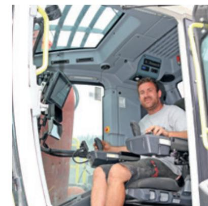
Über die beiden Joysticks und weitere Bedienelemente stehen Bohrist Thomas Watzenegger in der neuen Sandvik iCab über 30 Funktionen zur Verfügung.
