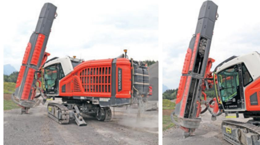
Bei den Modellen der Ranger DXi-Familie ist der Silencer in geschlossener Form fix verbaut. Zwei Öffnungen ermöglichen die optische Kontrolle der Bohrprozesse.
