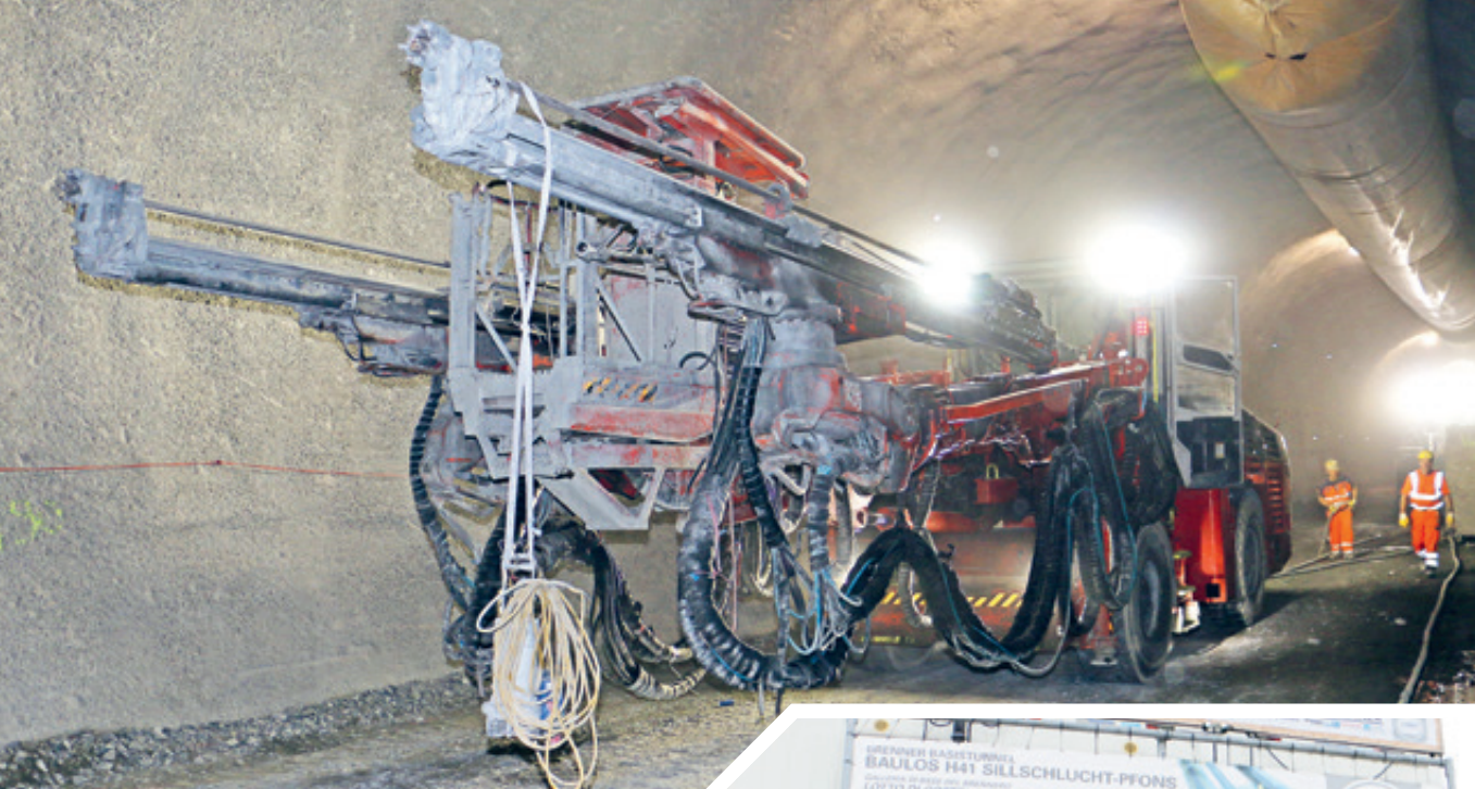
Der DT923i punktet mit einem schnellen und automatischen Bohrgestänge-Verlängerungssystem, einem zweifachen Roll-Over und neuen Hochfrequenz-Bohrhämmern der RD5-Serie.
