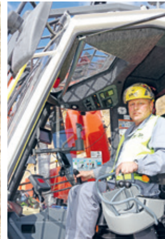
Bohrer Ernst Schaffer hat in der Kabine alle wichtigen Parameter unter Kontrolle. Der exakte Winkel für die Bohrungen wird über GPS Antennen am Dach sichergestellt.
